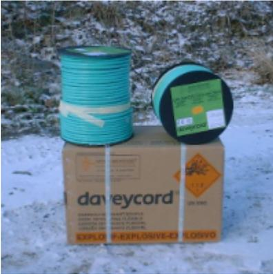
Le **DAVEYCORD** est un **cordeau détonant** constitué d'une âme de pentrite contenue dans une gaine textile et enrobée par une enveloppe plastique pour le protéger de l'humidité.
