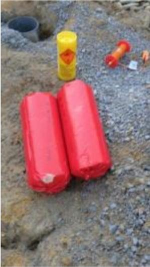
Bien qu'amenée à disparaître, la dynamite reste un explosif puissant, encore utilisé pour ses qualités détonantes en petit diamètre.
